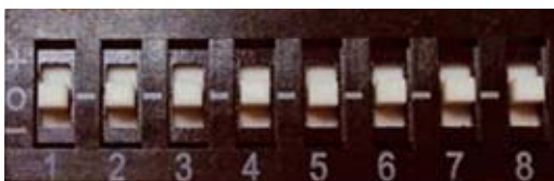
Fig. 3 - Un dip switch modello 3-state.
